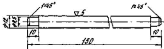
Рис. 11. Корпус пробоотборника (10). Ст. 3
