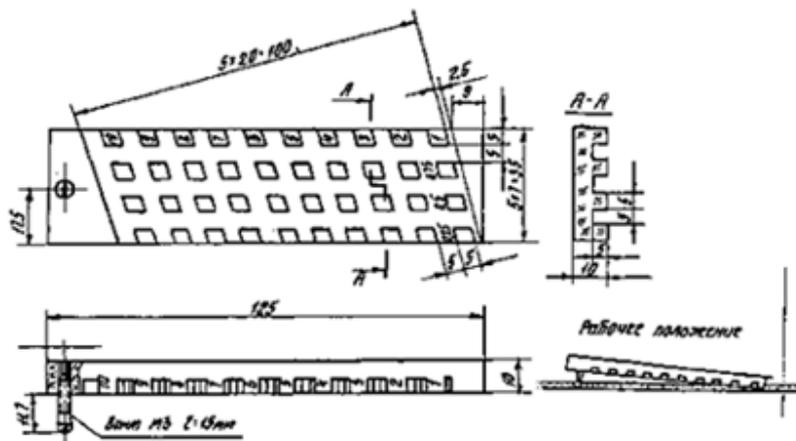
Рис. 4. Оптическая линейка ОЛ-1
