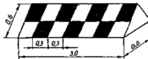
измерении составляет менее 4,5 м, должны окрашиваться чередующимися по цвету полосами шириной 1,5 - 3,0 м. Полосы наносят перпендикулярно большему измерению и крайние окрашивают в темный цвет (рис. 3.26, в).
