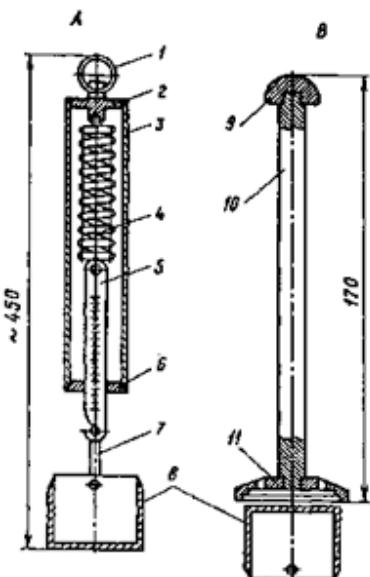
Рис. 4. Пружинный плотномер.
