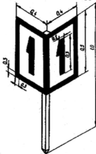
Рис. 3.22. Маркировочный знак для обозначения мест стоянок ВС
