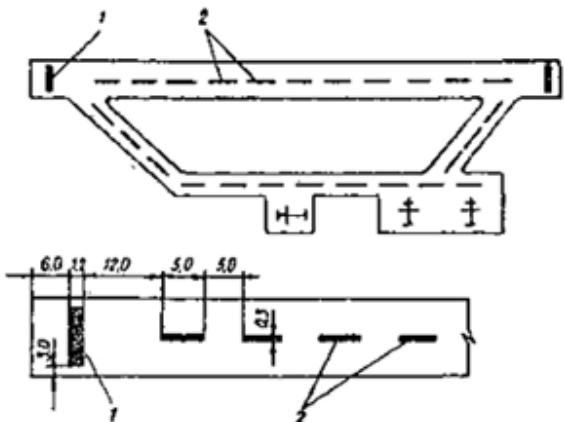
Рис. 3.5. Схема маркировки ИВПП неклассифицированных аэродромов:
