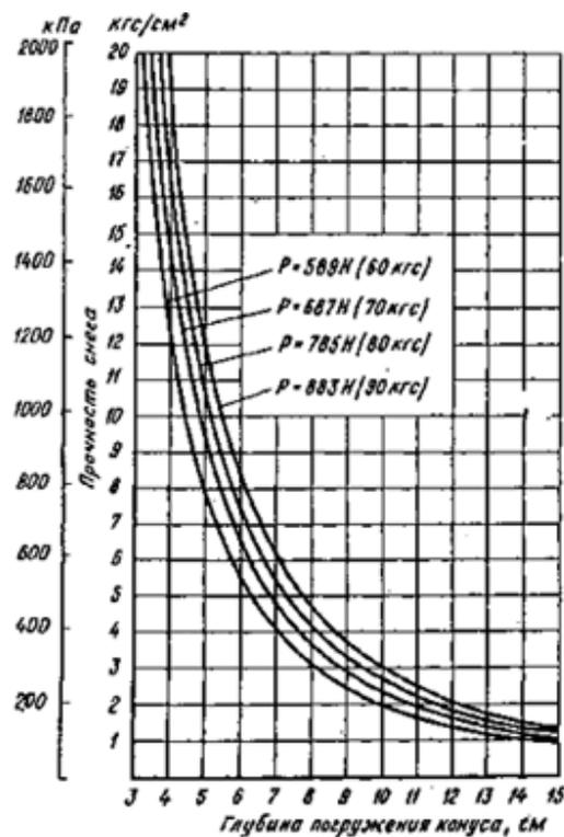
Рис. 3. Зависимость глубины погружения конуса от прочности снега.
