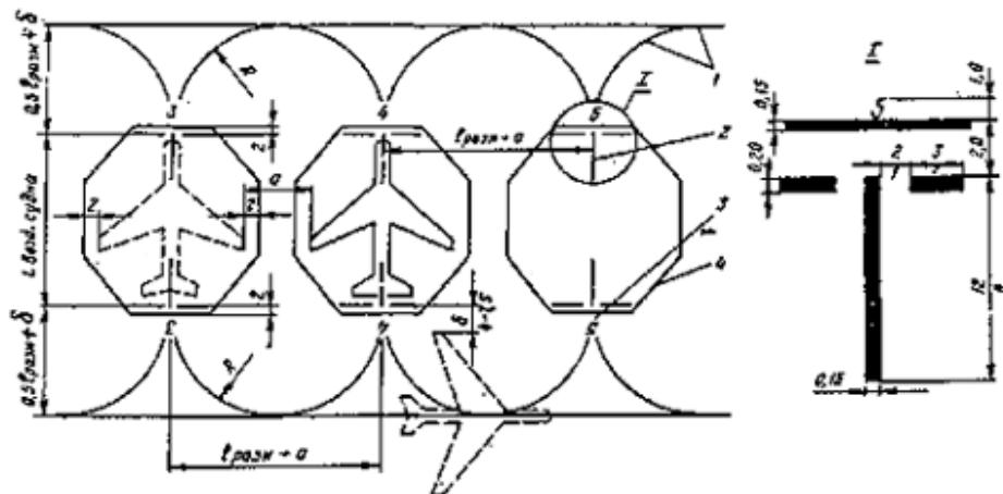
Рис. 3.8. Схема маркировки перрона: 1 - оси руления ВС; 2 - обозначение номера стоянки; 3 - Т - образный знак места остановки ВС на стоянке; 4 - зона обслуживания ВС; 5 - знак "Т" для остановки спецмашин; 6 - пути движения спецмашин; 7 - разделительная ось пути движения спецмашин; 8 - разрешение на въезд и выезд спецмашин; 9 - разрешение только на выезд спецмашин; 10 - разрешение только на въезд спецмашин.
