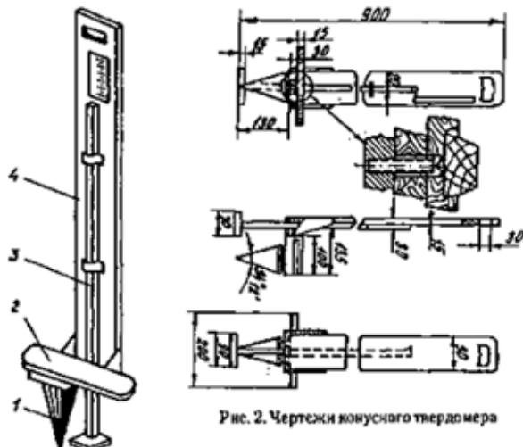
Рис. 2. Чертежи конусного твердомера
