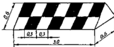
Рис. 3.24. Знак для обозначения опасных мест
